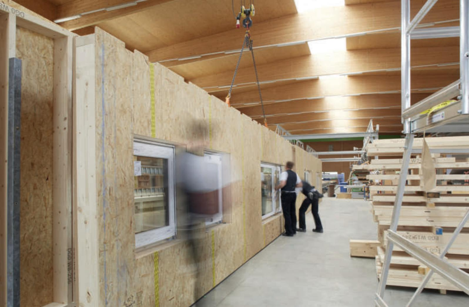
*Vorfertigung von Wandelementen mit im Werk eingebauten Fenstern*
